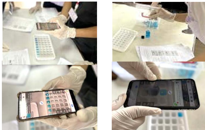
รูปที่ 2 แสดงตัวอย่างการทดลองใช้ชุดทดลองเคมีย่อบาง เรื่องปัจจัยที่มีผลต่ออัตราการเกิดปฏิกิริยาเคมี ร่วมกับแอปพลิเคชัน Color Picker
